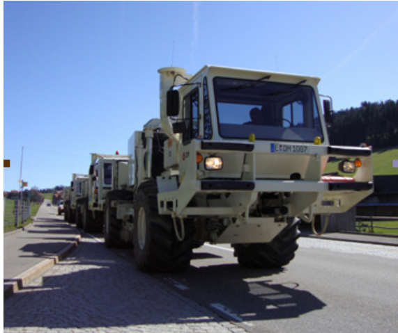
Vibrationsfahrzeuge für die seismischen Messungen in Eggersriet im April 2010
